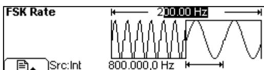
图 3-10 输出 FSK 调制波形
