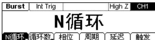
图 2-45 N 循环脉冲串设置界面
