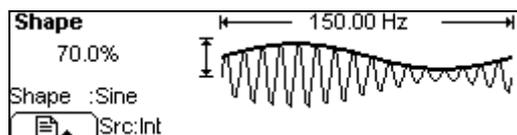
图 3-9 输出 AM 调制波形
