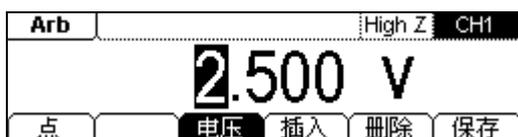
图 2-29 编辑第 1 个点的电压值
